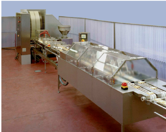
Автоматична лінія та готовий продукт — налисник, складений «конвертом»
